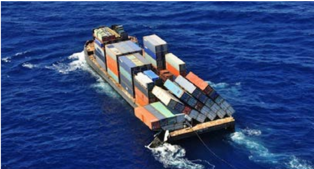
Figura 2. Tensiones mecánicas y dinámicas resultantes en el transporte de contenedores ISO intermodales en barcasas. Fuente: Google © SM ™®
