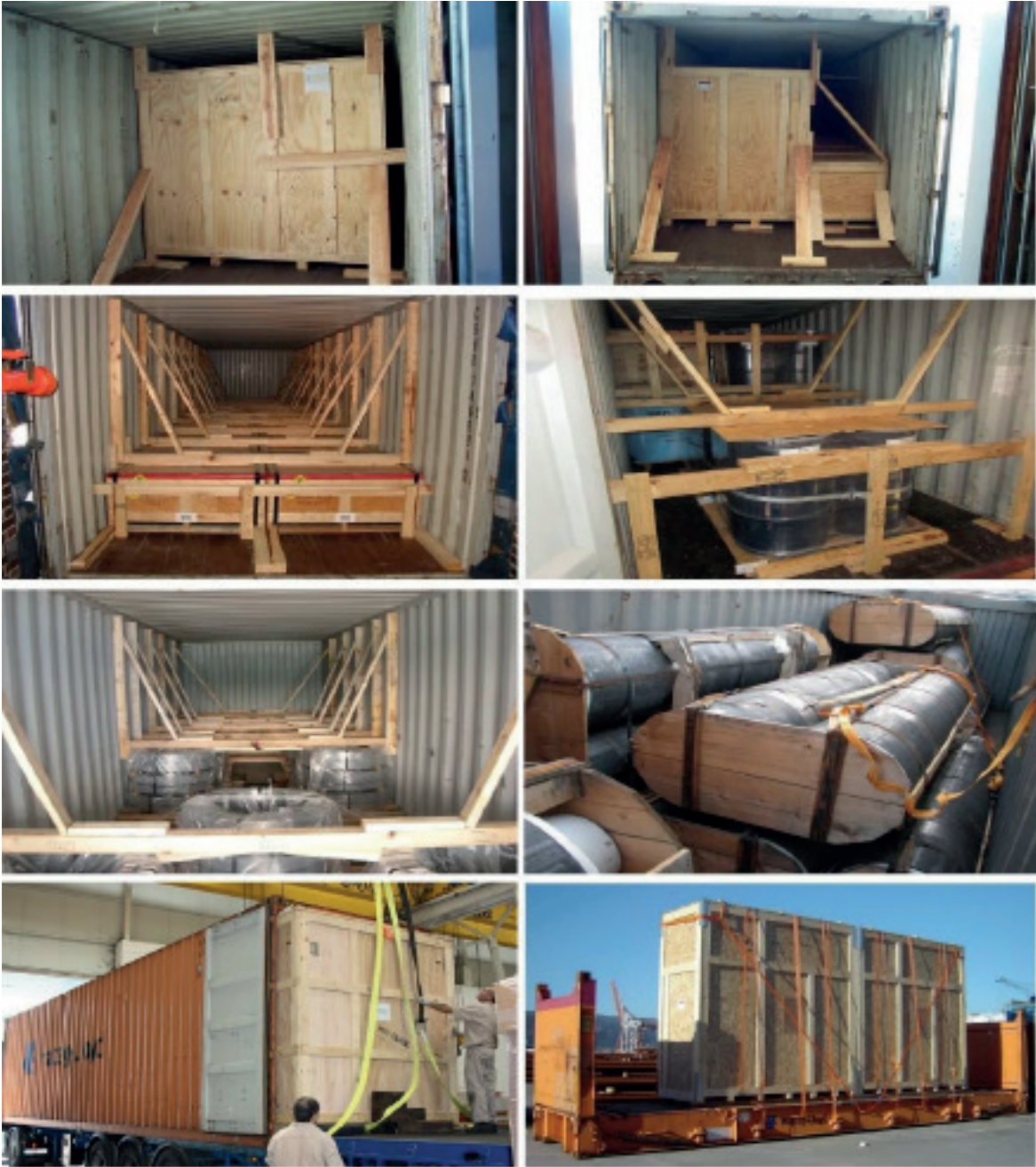
Figura 4. Material de Estiba de Madera (MEM) empleado en la manipulación, fijación, sujeción y trincaje de cargas contenedorizadas. recopilación del autor; Google ©SM TM®
